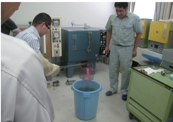
850℃に加熱された試験片を水冷します
