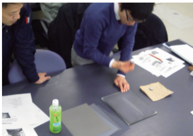
自分たちで熱処理した試料で組織を見るために、鏡面に仕上げます
